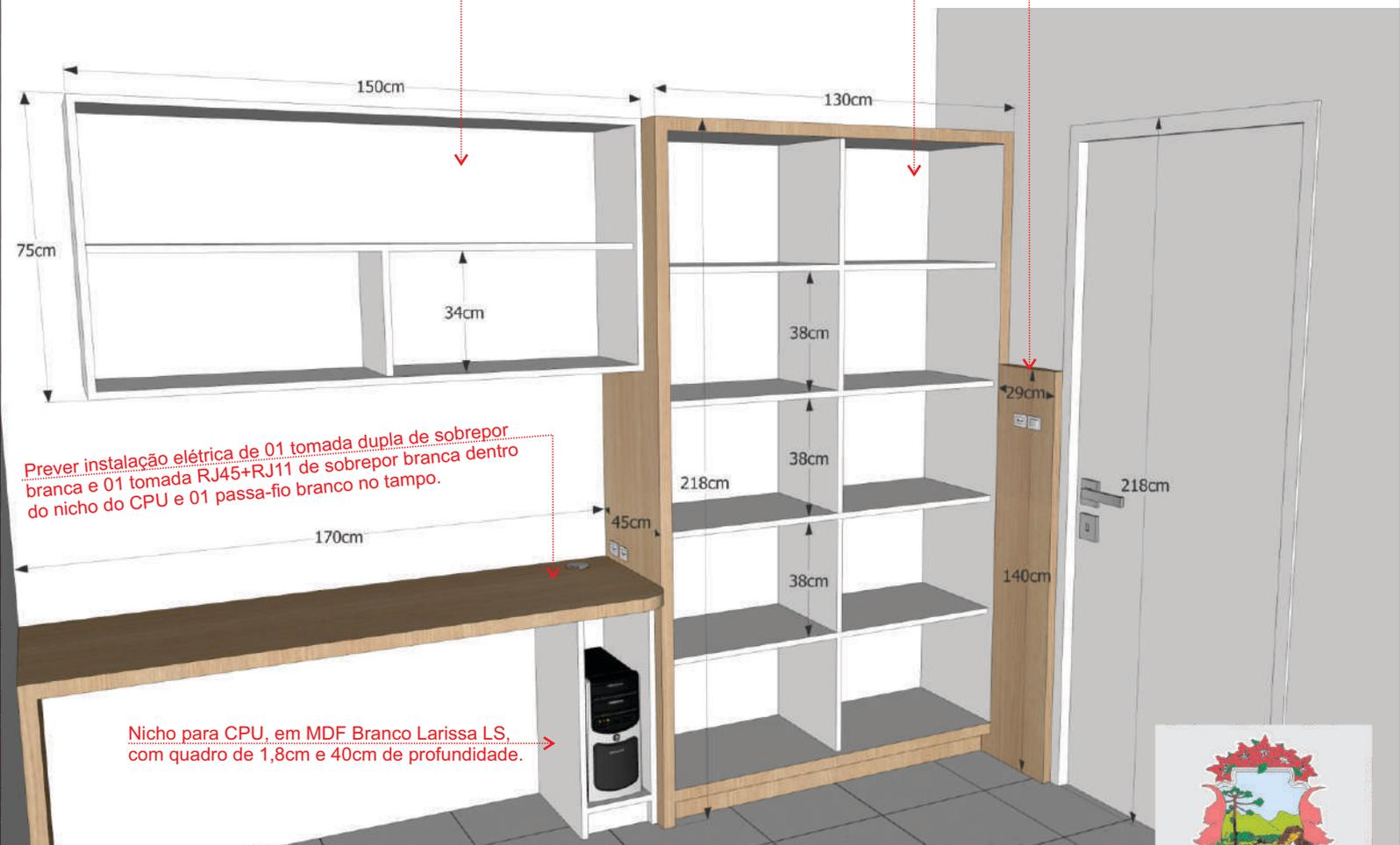
Prever instalação elétrica de 01 tomada dupla de sobrepôr branca e 01 tomada RJ45+RJ11 de sobrepôr branca dentro do nicho do CPU e 01 passa-fio branco no tempo.
