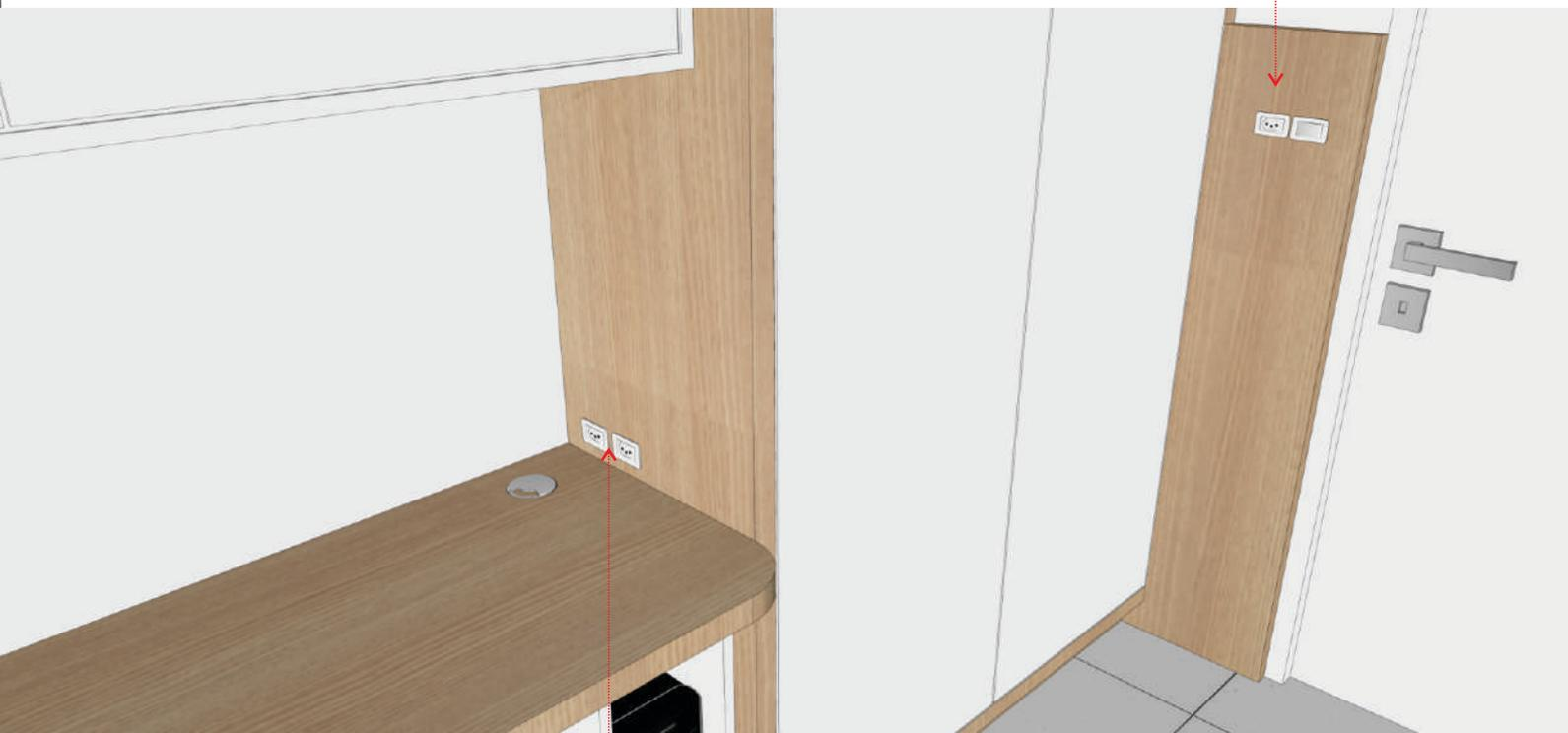
Prever instalação elétrica de duas tomadas na lateral do armário - modelo de embutir, branco, aprox. 6,6x3cm.
