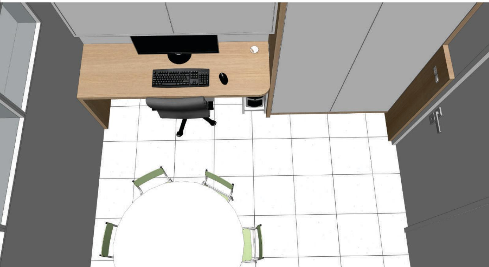
Prever instalação elétrica de 01 tomada dupla de sobrepor branca e 01 tomada RJ45+RJ11 de sobrepor branca dentro do nicho do CPU e 01 passa-fio branco no tampo.
